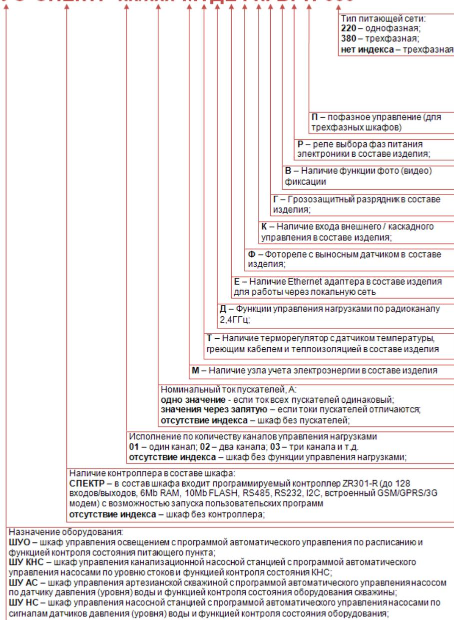
Таким образом, **ШУО СПЕКТР-02/20-МТ-220** (контроллер СПЕКТР-PRO) является однофазным шкафом управления освещением, с двумя с пускателями по 20А, со счетчиком электроэнергии и обогревом.
