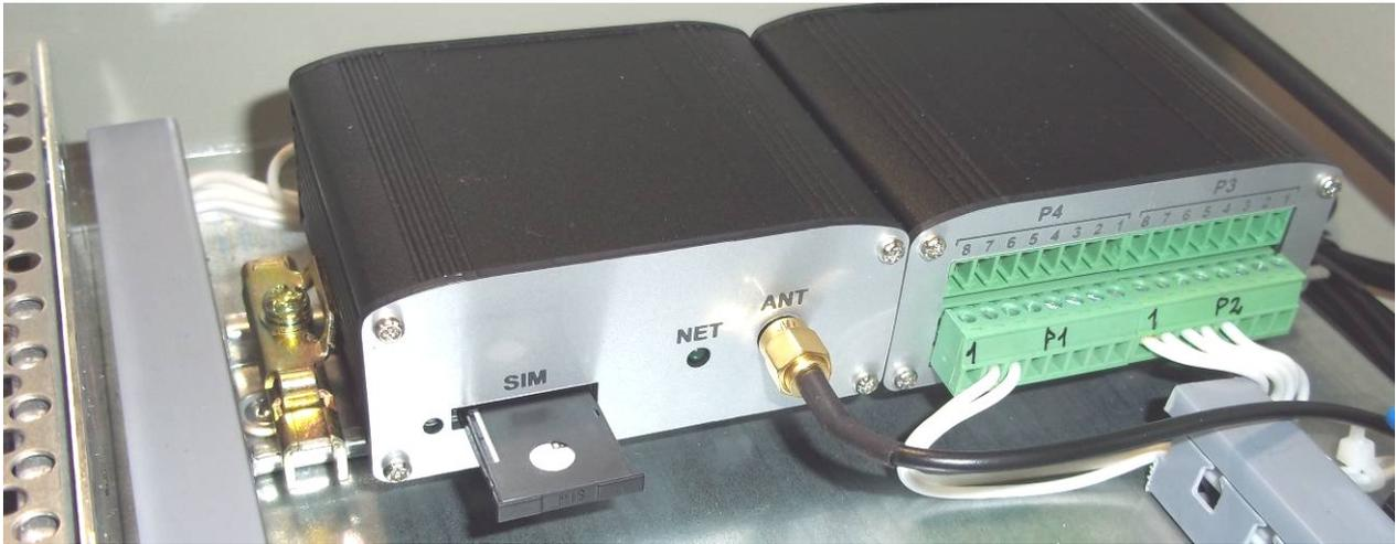
При установке лотка нужно следить за тем, что бы он попал в отведенные для него пазы. Правильно установленный лоток с сим-картой входит в контроллер плавно и без лишних усилий.
